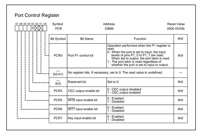
PCR4 (CEC output enable bit) (b4)
